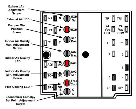
FIGURE 10 - HONEYWELL ECONOMIZER CONTROL W7212
